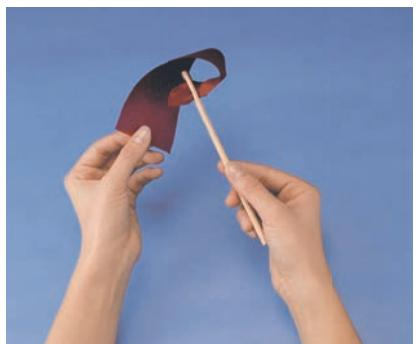
2. Mit Drehbewegung des Wischerstabes das Tuch um den Wischerstab wickeln ...
