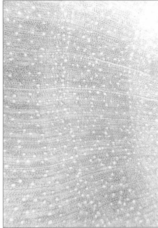
Abb. 3: Buchsbaum, Holz quer, mehrere Jahresringe zeigen an, daß das Holz aus einem Gebiet mit winterlichem Wachstumsstillstand kommt, Vergr. 80f
